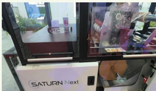
НОВИНКА: перемотчик SATURN, ширина полотна 450 мм, с автоматизированной системой инспекции, отбраковки и замены дефектной этикетки без участия оператора
