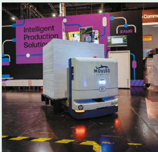
Автономный мобильный робот Sharko5, предоставленный MoviGo Robotics и HP, способен перевозить паллеты в типографиях
