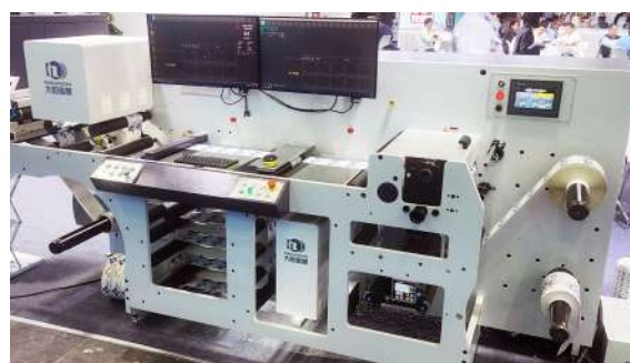
Устройство 100% контроля качества печати этикеток DAHENG IMAVISION
