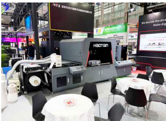
Двухсекционная струйная УФ-машина Naotian для цифровой печати и облагораживания этикетки
