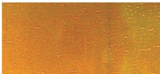
Проколы (точечные дефекты)
